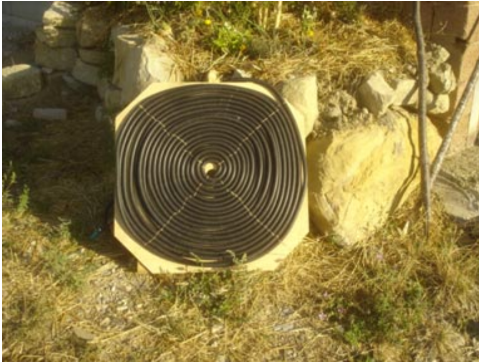
Ducha solar realizada con una tubería de polietileno negra.
